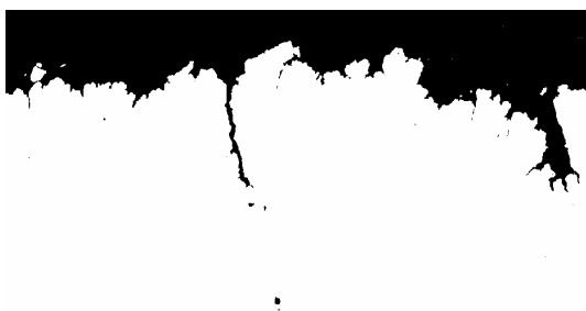
Obr. 2.35: Transkrystalová koroze oceli (zvětšeno 500 x)
