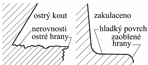
Obr. 2.26: Řešení geometrie povrchu; nesprávně (vlevo), správně (vpravo)
