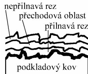
Obr. 3.9: Skladba rzi na ocelovém podkladu po pěti letech expozice
