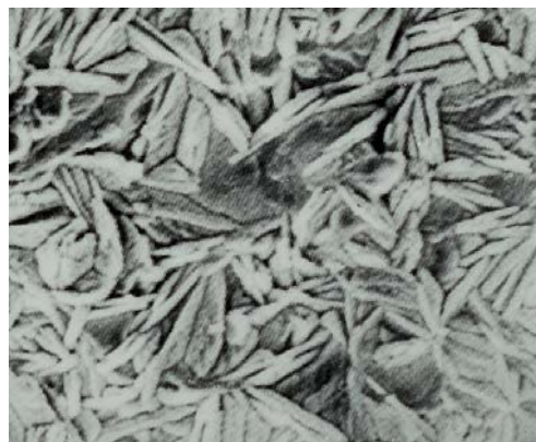
Obr. 3.5: Struktura fosfátové vrstvy
