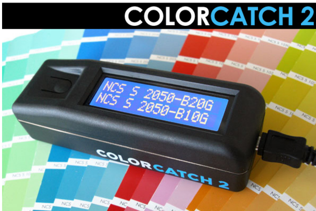
Obr. 2 – Zařízení Color Catch 2 pro hodnocení barevného odstínu nátěru
